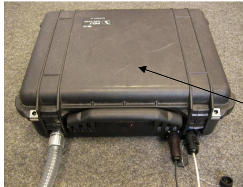
Temperaturmessgerät mit IP65 Gehäuse und Verschraubung
